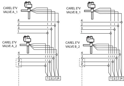
Примечание: работа в параллельном и комплементарном режиме может использоваться только для вентилях CAREL, с учетом ограничений, указанных ниже в таблице, где ОК означает, что вентиль можно использовать с любыми хладагентами при номинальном рабочем давлении.
