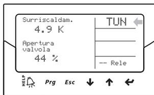
Процедура оптимизации может проводиться только, если привод находится в состоянии регулирования, и длится от 10 до 40 минут, при этом выполняются специальные перемещения вентиля и замеры контрольных переменных.
